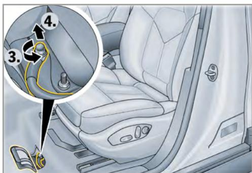
3. 斷開螺絲接線端 (-3-) 的 12 伏特電池接地纜線。
