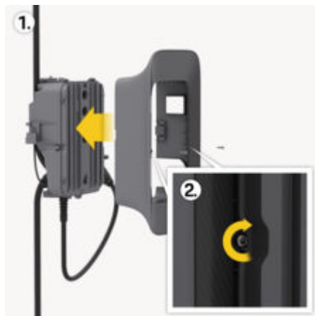
Fig. 47: Fissaggio telaio di design
