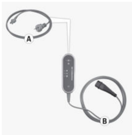
Fig. 48: Conexiones en la unidad de control
