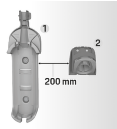
H. 135: Khoảng cách giữa đế gắn tường và chốt đầu nối
