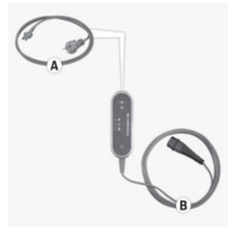
Fig. 84: Conexiones en la unidad de control
