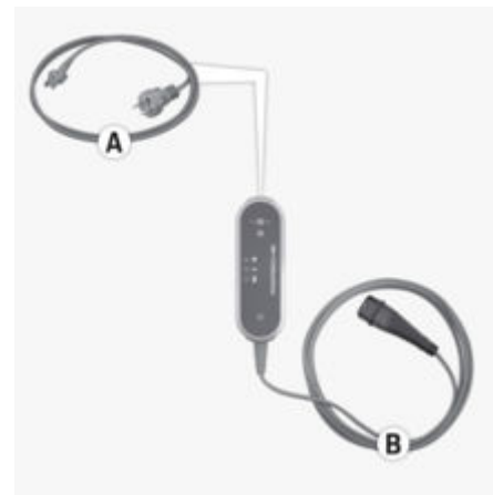
Att. 464 Savienojumi vadības blokā
