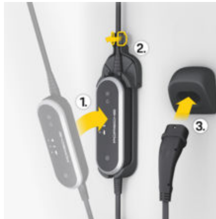
Fig. 229 Hekte på betjeningsenheten
