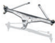
フロントウインドウワイパー システム用フレーム 部品番号 94462892000
