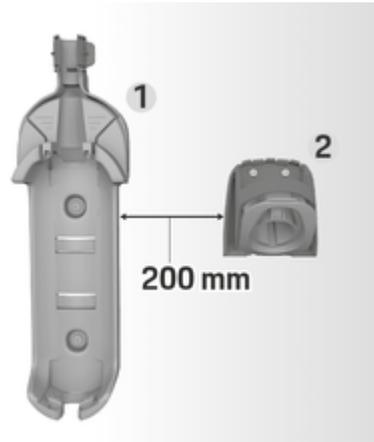
Fig. 4: Distancia entre el soporte de pared y el soporte de enchufe
