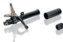
**Estructura de amortiguador, izquierda**
