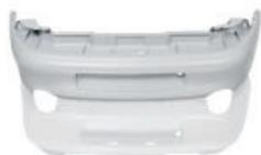
**Revestimiento del parachoques trasero, imprimado**
