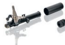
**Estructura de amortiguador, derecha**
