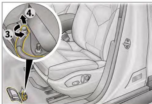
3. ネジ部の接続(-3-) から12Vバッテリーのマイナス・ケーブルを切り離し、誤って接触しないよう固定します(-4-)。
