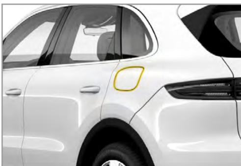
車両後方左側の充電ソケット・リッド裏側にある**車両充電接続口**
