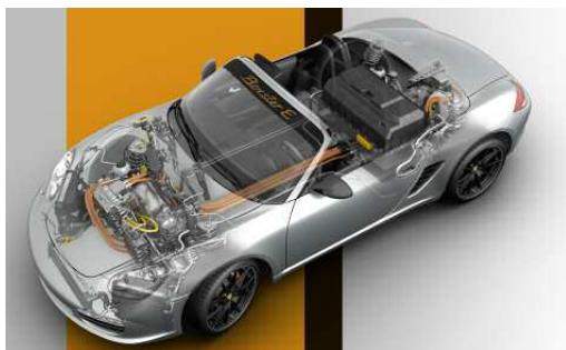
E comme économique : deux moteurs électriques agissent sur les essieux avant et arrière.
