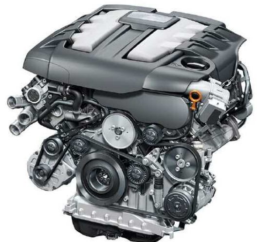
Le moteur 3 litres du Cayenne Diesel
