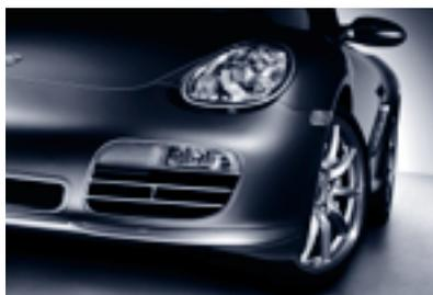
Sur le plan optique, les lèvres du spoiler avant ont pour effet d'abaisser la silhouette du Boxster et d'accentuer son dynamisme. Le spoiler arrière à déploiement automatique est conçu selon le principe de l'aileron fendu, déjà connu sur la Porsche 911 Turbo, alors que le revêtement de la partie arrière en forme de diffuseur s'inspire de la Carrera GT.
