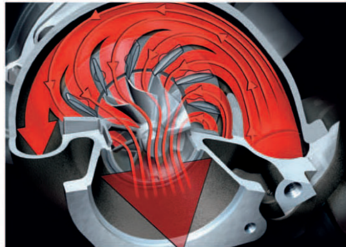
导流叶片关闭后的废气流 (低发动机转速)
