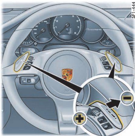
带换挡按钮的方向盘
