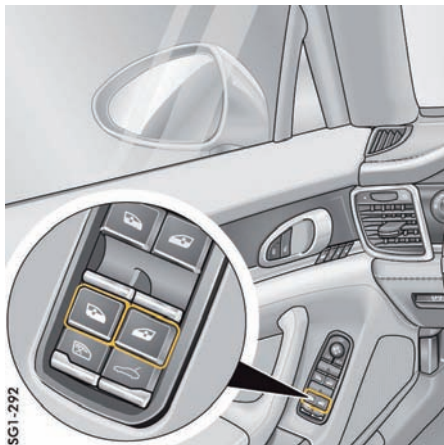
驾驶员侧车门上的电动车窗 / 遮阳卷帘按钮
