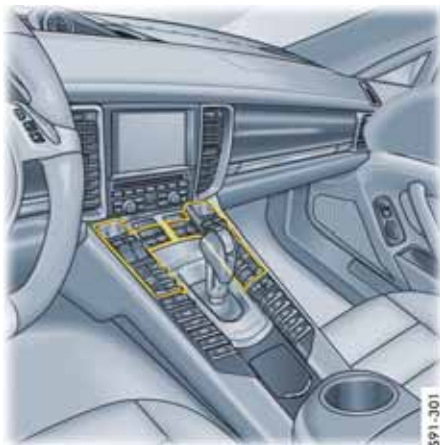
前部空调控制面板
