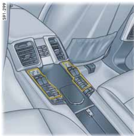
后部空调控制面板（4 区域空调）
