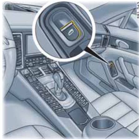
乘客侧车门中的电动车窗开关
