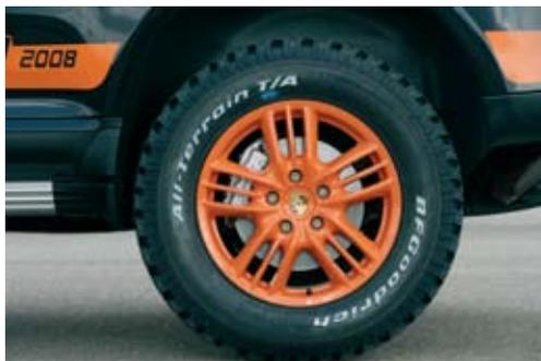
BF Goodrich（百路驰）提供的越野轮胎，将离地间隙提高了30 mm
