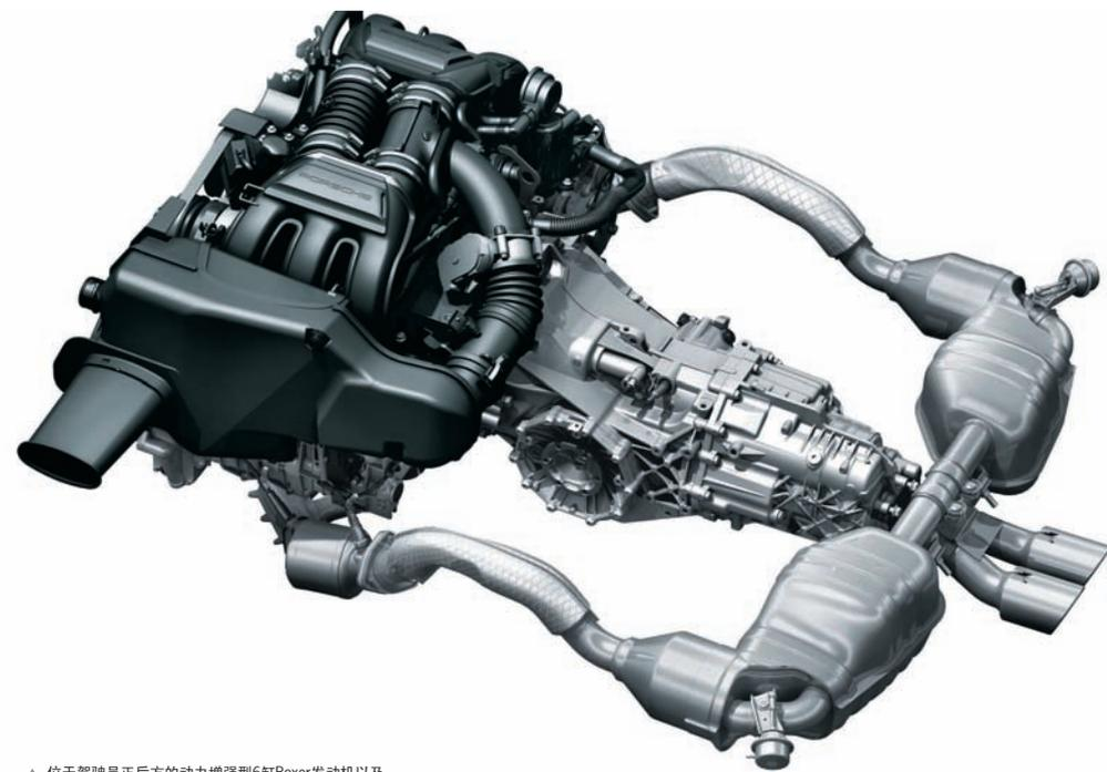
▲ 位于驾驶员正后方的动力增强型6缸Boxer发动机以及带双支管尾管的标准运动型排气系统
