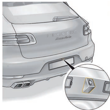
图 193: 倒车摄像头位于保险杠中的牌照灯之间。
