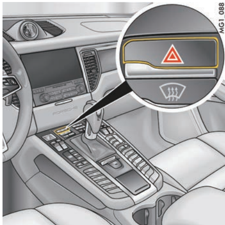
图 46: 中控台上的危险警示灯按钮
