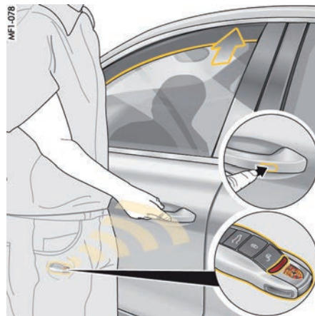
图 37: 使用门把手上的接近传感器关闭车窗 (配备保时捷免钥匙进入系统的车辆)
