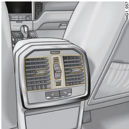
图 129: 后冷气空调控制面板
