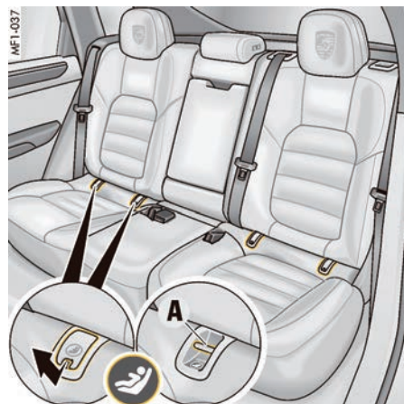
后排外侧座椅上的 ISOFIX 固定系统
