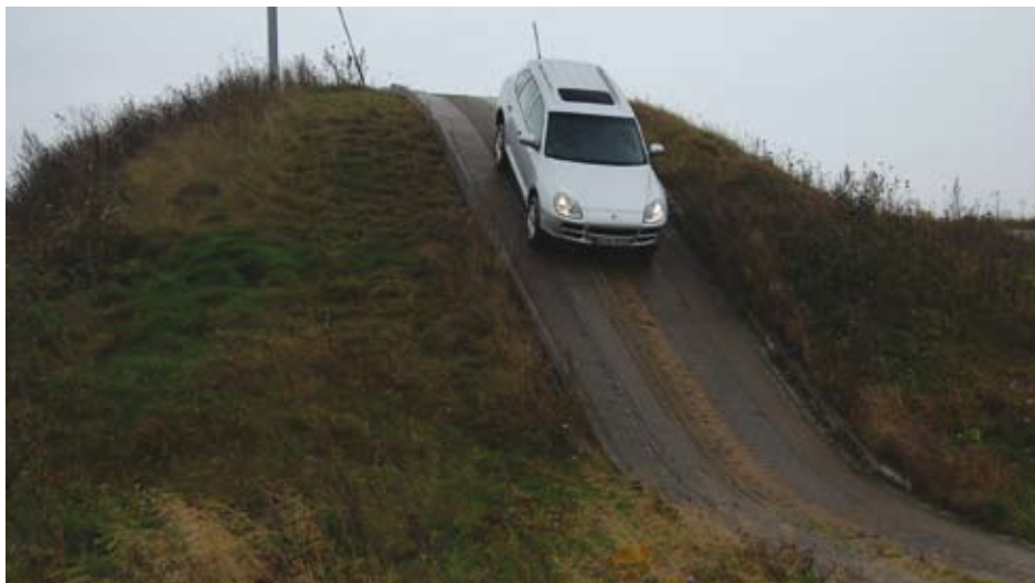
莱比锡工厂内拥有超过40度倾斜角的越野坡道
