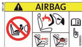
遮阳板上的安全气囊警告标签
