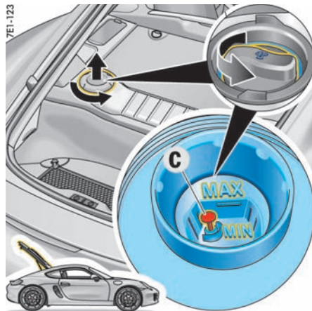
C - 冷却液液位指示器
