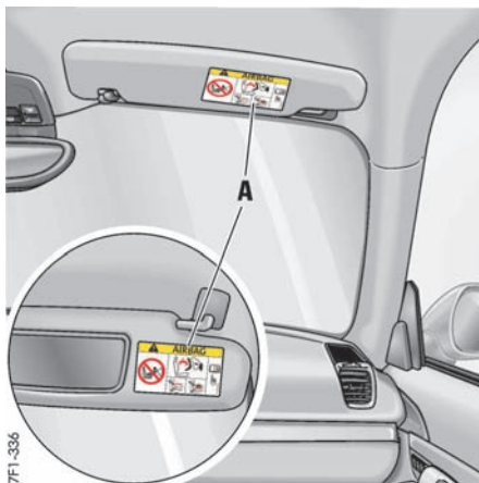
遮阳板上的安全气囊警告标签
