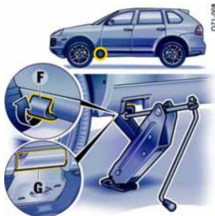
带有车门槛护板的车辆 前部举升点
