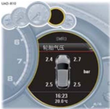
多功能显示器上的轮胎气压显示
