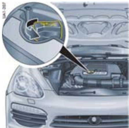
V6 发动机上的机油加注点
