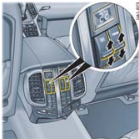
温度和风量，后部控制面板（四区域自动恒温空调）
