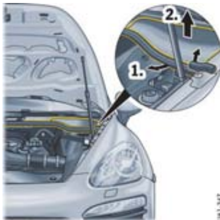
打开发动机舱内的保险丝盒罩盖 1. 拆下盖罩。
