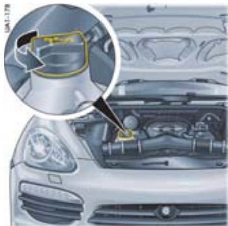
V8 发动机上的机油加注点
