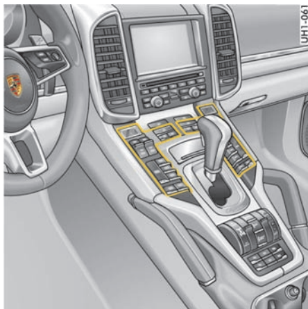
前部空调控制面板
