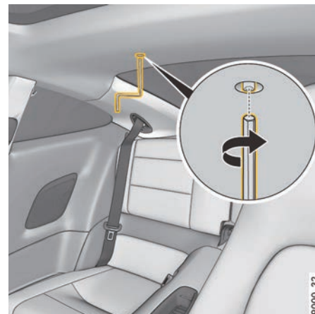
图 146: 用六角扳手关闭可倾 / 滑动式天窗
