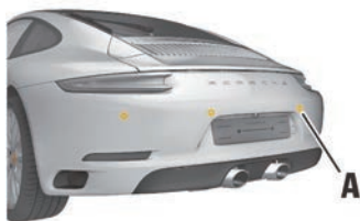
图 200: 用于车距测量的超声波传感器
