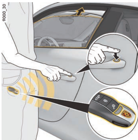
图 34: 使用门把手上的接近传感器关闭车窗（配备保时捷免钥匙进入系统的车辆）
