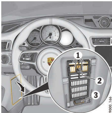
图 9: 左侧脚坑的保险丝盒中的元件
