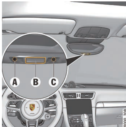
图 107: 内后视镜的自动变光功能
