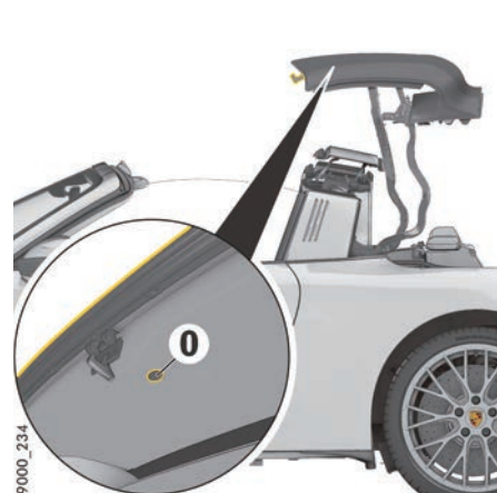
图 194: 取下接入点处的塞子，以便进行天窗锁扣紧急操作
