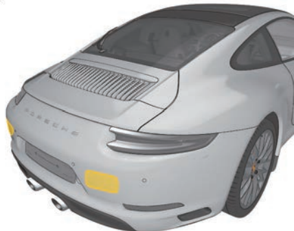
图 36: 后保险杠上的雷达传感器
