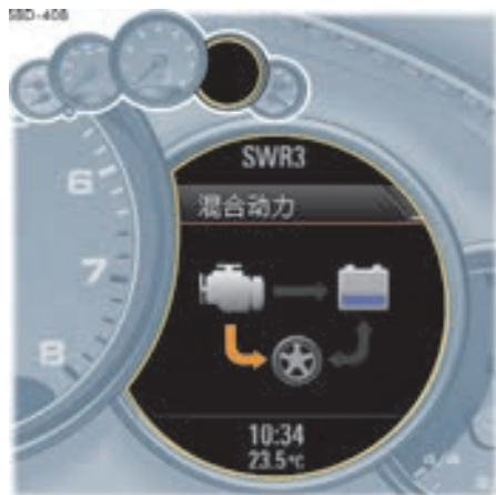
通过内燃机驱动 内燃机驱动车轮。
