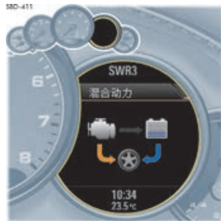
通过内燃机和电机驱动 内燃机和电机同时驱动车轮（例如，在超级加速过程中）。高压蓄电池在此过程中放电。
