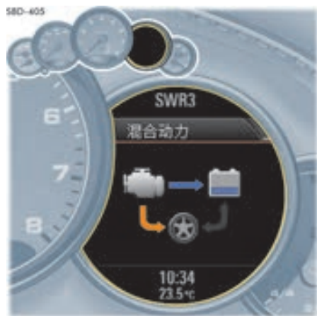
通过内燃机驱动并为高压蓄电池充电 内燃机驱动车轮并通过电机为高压蓄电池充电，此时电机相当于发电机。 同时为高压蓄电池充电会将内燃机的负荷点向上移动。因此，内燃机在最佳效率范围内工作。
