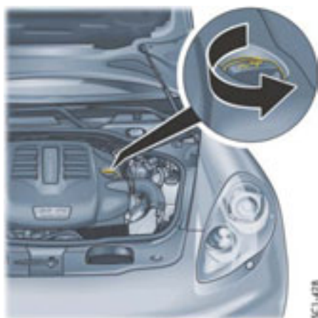
机油加注点 (Panamera Diesel)
