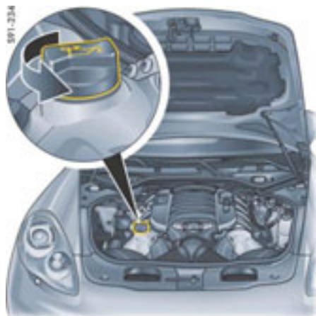
机油加注点 (非 Panamera S Hybrid 或 Panamera Diesel)
