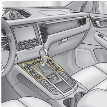
前部空调控制面板
