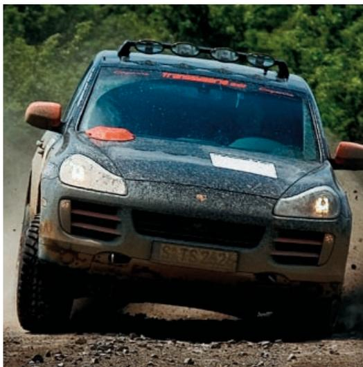
Para oferecer ainda maior proteção, o Cayenne S Transsyberia possui estrutura de segurança acoplada à célula que forma o habitáculo. Esta estrutura segue as regras e exigências da FIA, com o piloto sendo protegido também por um airbag. O peso extra da estrutura de segurança e dos equipamentos para rali é compensado pela remoção do assento traseiro, dos painéis de
