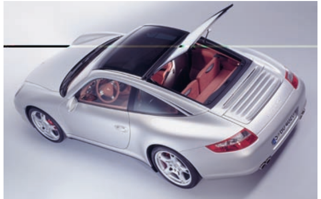
Teto de vidro, pára-brisa traseiro basculante e estilo diferente da extremidade da janela lateral traseira diferenciam o Targa. O interior é idêntico ao dos 911 Carrera.
