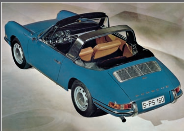
A evolução do Targa. Acima, uma unidade de 1967, com arco transversal e capotas de lona. À direita: acima, modelo de 1993, com a janela traseira de vidro adotada em 1969; embaixo, o Targa de 1997, o primeiro com teto de vidro e arcos laterais longitudinais.
