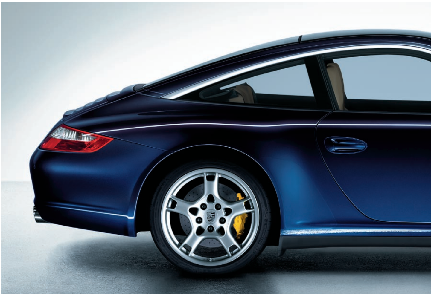
Teto de vidro, pára-brisa traseiro basculante e estilo diferente da extremidade da janela lateral traseira diferenciam o Targa. O interior é idêntico ao dos 911 Carrera.
