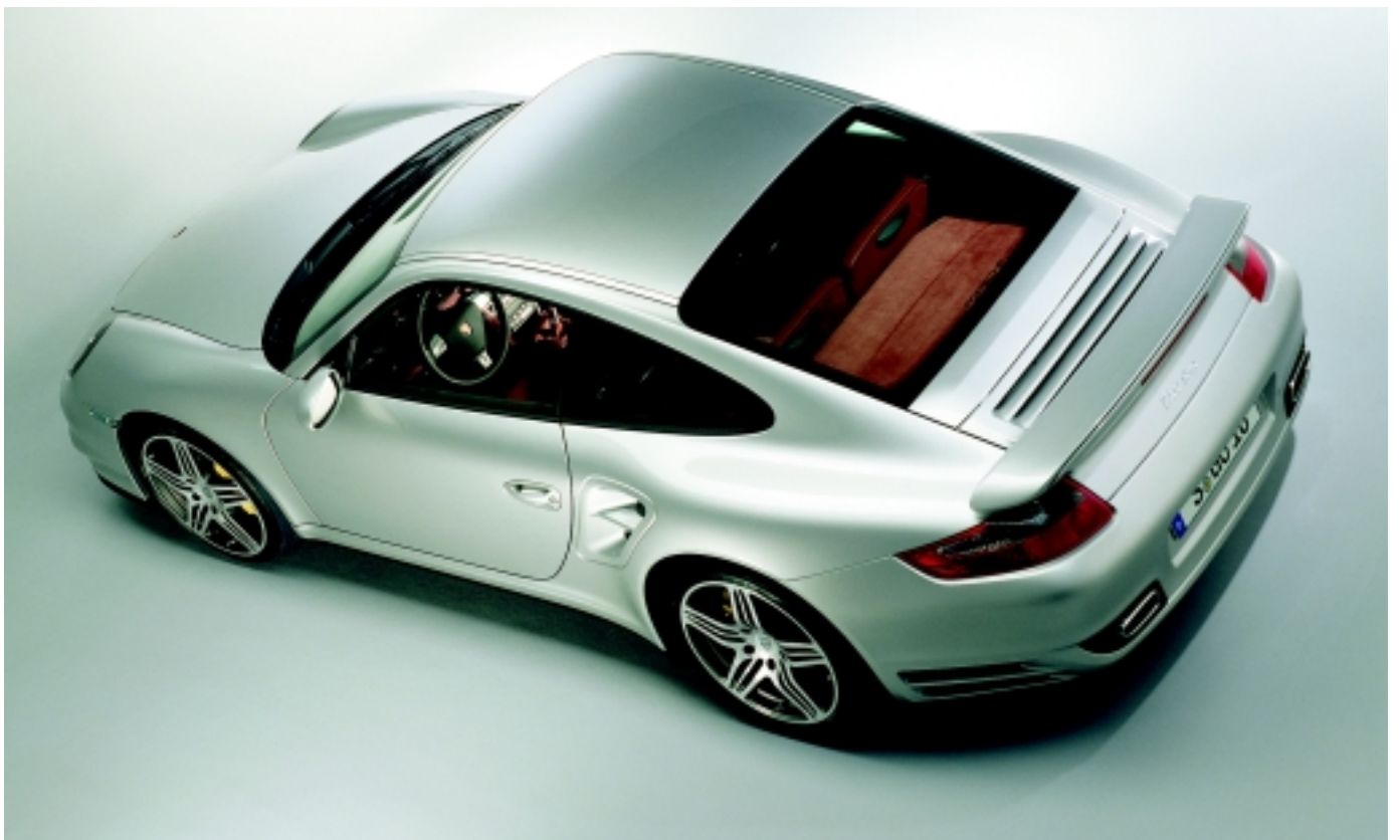
Detalhes que diferenciam a traseira do novo 911 Turbo: entradas de ar nas laterais, asa traseira e escapamentos integrados ao pára-choque.
