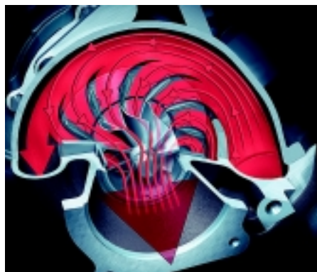
Varição do ângulo de abertura das palhetas das turbinas. Elas se "abrem" à medida que a rotação do motor aumenta.
