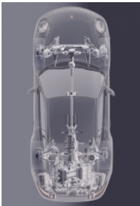
O sistema de tração integral transmite um mínimo de 5% da potência do motor para as rodas dianteiras. Se necessário, a proporção pode chegar a 40%.
