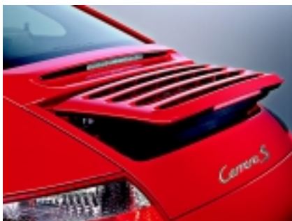
O Carrera S se diferencia do Carrera por ter motor mais potente (355 cv). Como em outros Porsche a asa traseira ergue-se quando o carro atinge 120 km/h. O nível de equipamento e o conforto são dignos de um carro de luxo.
