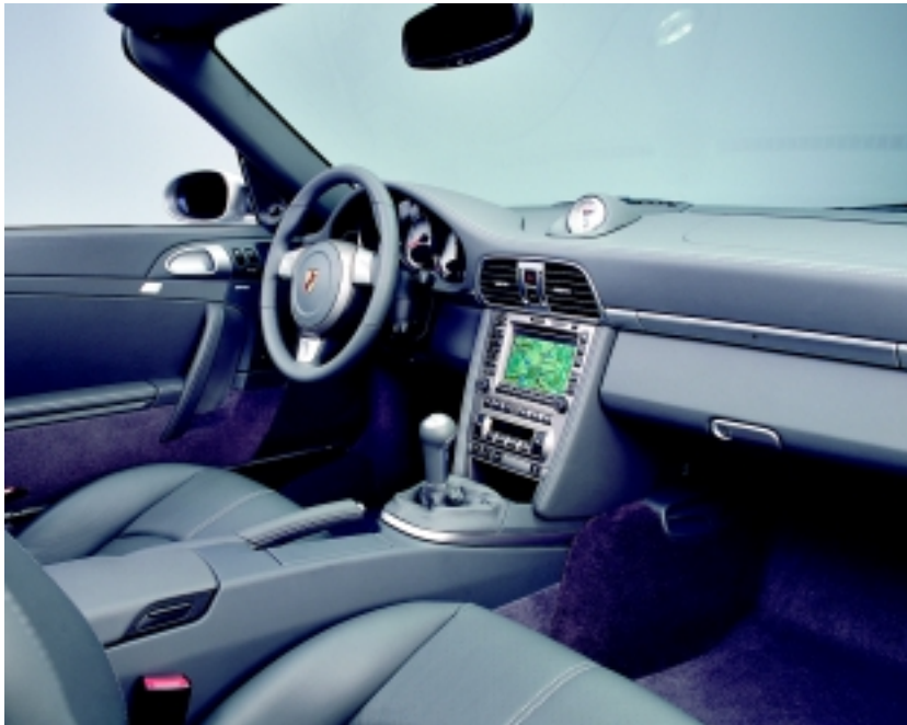
O Carrera S possui motor mais potente e equipamentos que no Carrera são opcionais. Entre eles estão o Sport Chrono (cujo cronômetro pode ser visto na parte superior do console central) e regulagens dos apoios laterais dos bancos. A asa traseira levanta automaticamente a 120 km/h ou ao toque de uma tecla no painel.
