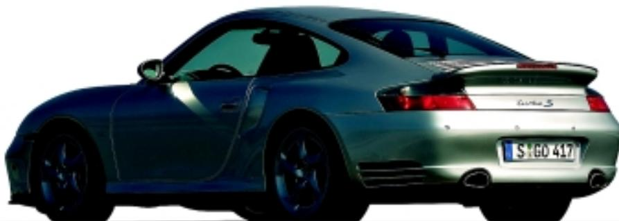
**Carroceria Coupé** – Cupê, estrutura monobloco, construção leve em aço estampado e galvanizado a quente em ambos os lados, airbags frontais e laterais para motorista e passageiro dianteiro, 2 + 2 lugares
