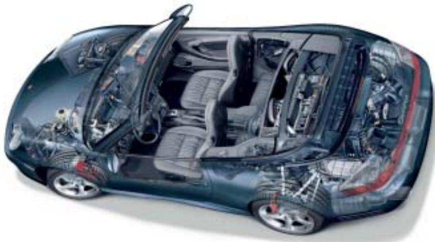
motor aspirado tem 3,6 litros e 6 cilindros contrapostos (boxer), rendendo 320 cv de potência. Com a capota fechada, o Porsche 911 Carrera 4S Cabriolet com transmissão manual pode alcançar velocidade máxima de 280 km/h. A aceleração de 0 a 100 km/h é feita em 5s3, apenas 0s2 mais lento que o Coupé. Uma marca expressiva, já que o Cabriolet, devido aos re-
