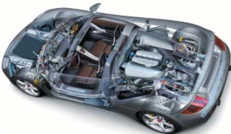
vedação. E o sistema VarioCam (patenteado pela Porsche e usado em outros motores da marca) assegura ajuste infinito do tempo de distribuição dos comandos de admissão numa faixa total de 40 graus.
